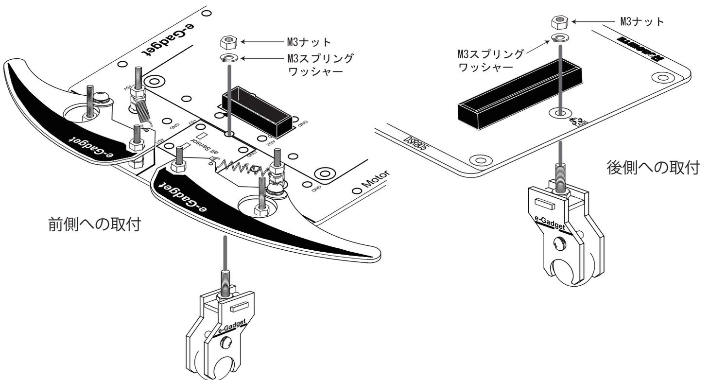
サッカー競技で高速な動きをさせる場合は前後にボールキャスターを取付けてください。
